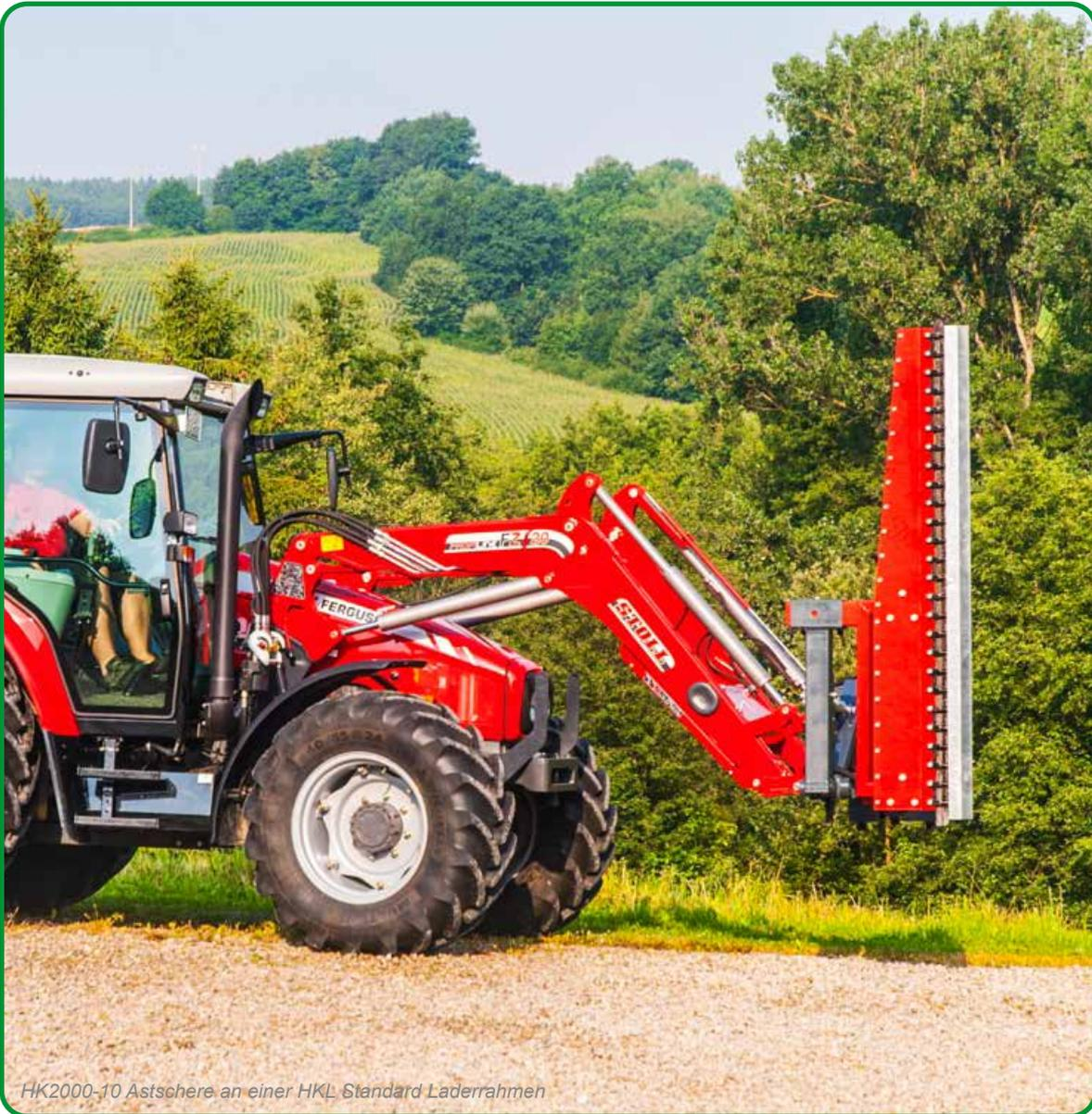
HK2000-10 Astschere an einer HKL Standard Laderrahmen
